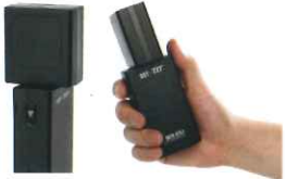
90°回転するアンテナ角度
